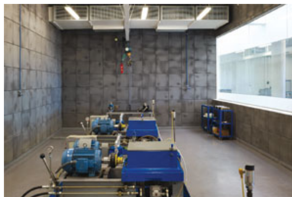
Nas salas de teste do terceiro anel, paredes estão protegidas por material metálico perfurado absorvente; alvenaria preenchida com areia atenua som em 40 dB
